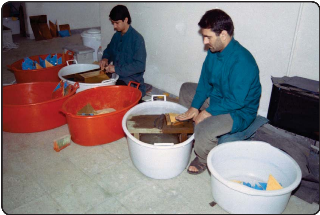
کارگاه طلا کاری و کارکنان مربوطه در حال سمباده زدن قالب های فلزی آب طلا کاری شده از سمت راست: جواد عرب نژاد، خسرو بیگی، داوود.
